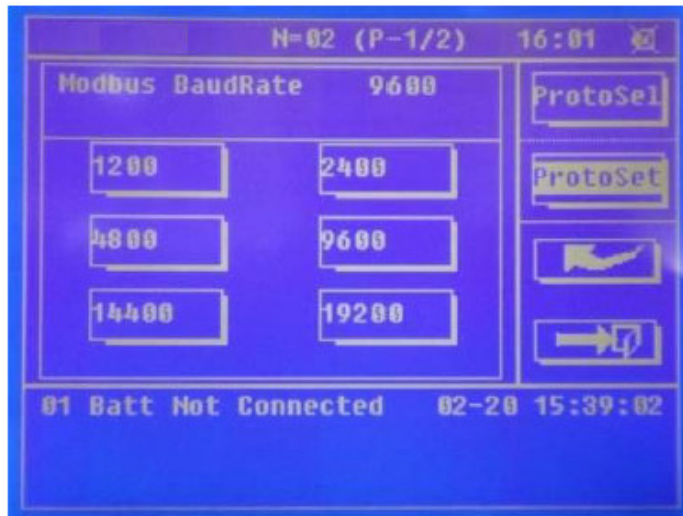
การตั้งค่าอัตรารับส่ง (Baud Rate) ของ Modbus
